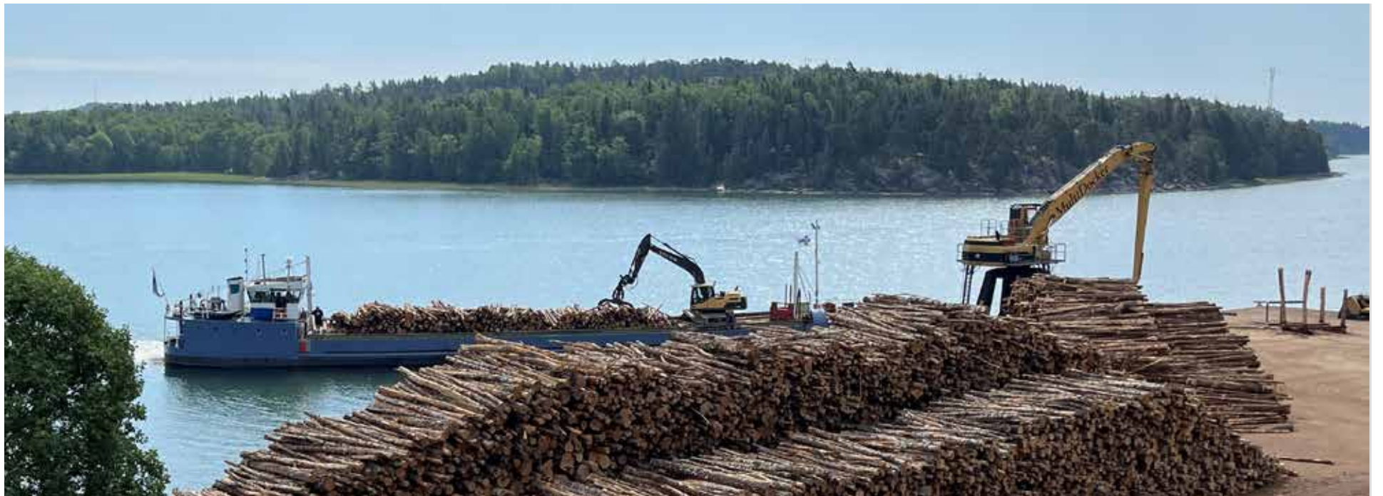
▲ M/v Leonie kan med hjälp av pråmar i stranden gå in till holmar och med egen kran effektivt lasta ca 550 m 3 per gång.
