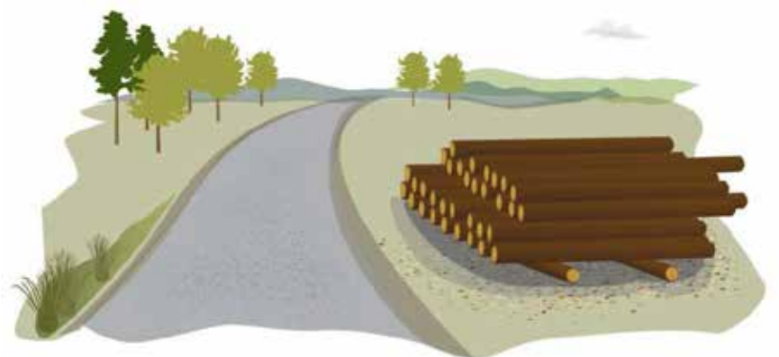
Bild 4. Trafiksäkert upplagd vältan. Utformningen förhindrar att enskilda stockar tränger in i kupén på en bil som kolliderar med vältan. (ill: Trafikverket Sverige)
